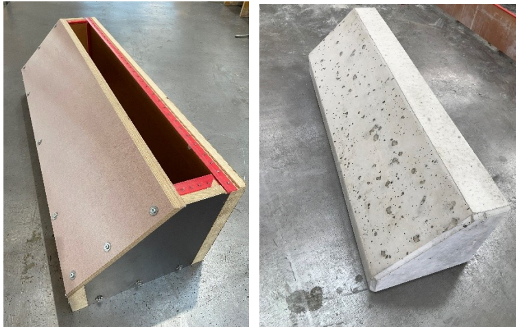
Abbildung 5.2: Zum Betonfertigteilelement geeignete Randschalung (links) kann zu Poren/Lunkern an der Oberfläche führen (rechts)
